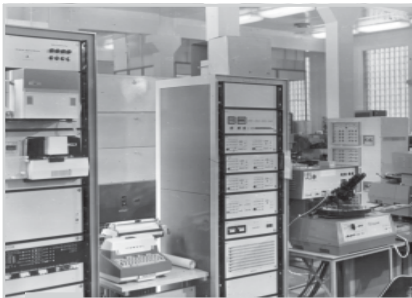
Автоматизированный комплекс «Интеграл» для измерения параметров интегральных микросхем
