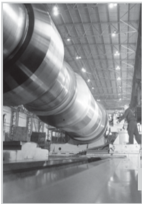
Обработка вала ротора гидрогенератора
