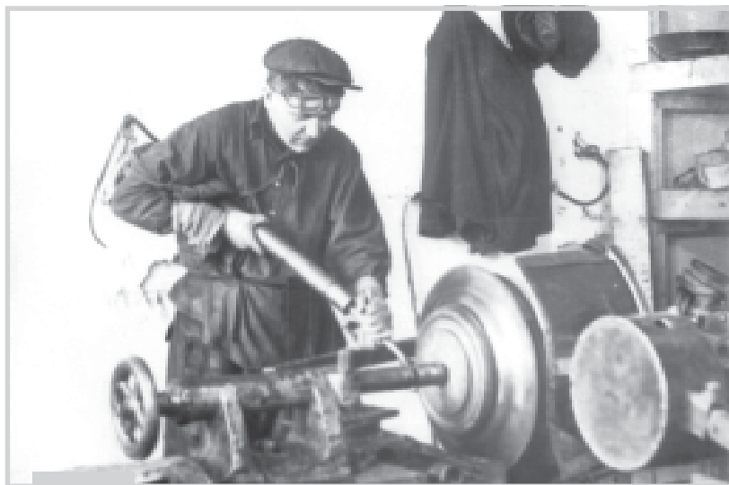
Токарь М. Самочернов за изготовлением таза на токарном станке. 1950 г.
