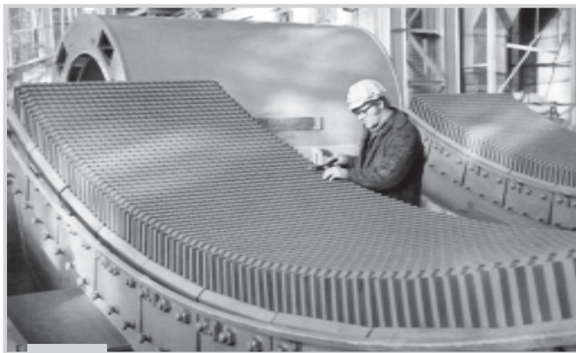
Подготовка секторов статора Нижнекамского гидрогенератора к укладке обмотки
