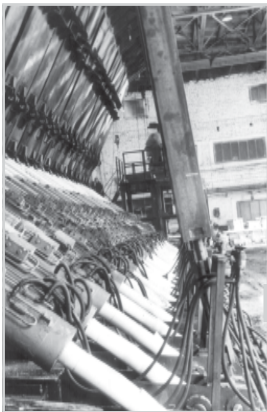
Поворотный стенд для натуральных испытаний комплексов, работающих на крутых пластах
